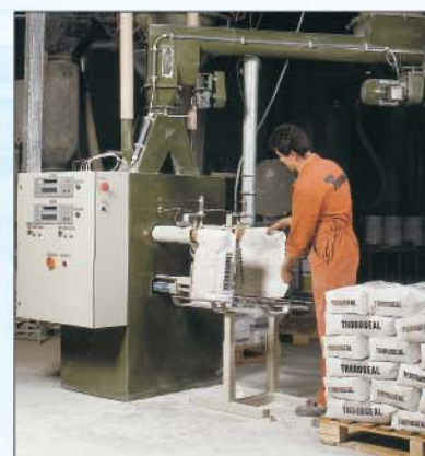
Podwójne urządzenie do napełniania worków. Wydajność: 400 szt./godz.
